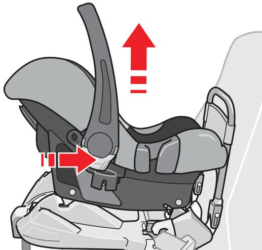
Drücken Sie den grauen Entriegelungsknopf **41** und kippen Sie die Babyschale gleichzeitig etwas nach vorne, bis die Raststange **X** am Fußende ausrastet.
